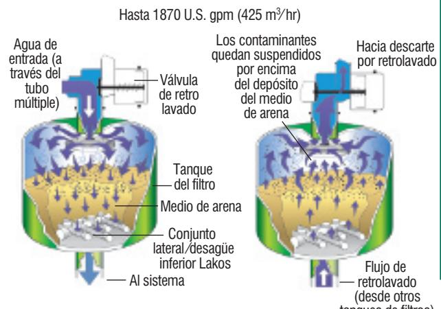
Diseñados para la efectiva remoción de materia orgánica, algas y partículas finas, los Filtros con Medio de Arena de la Serie SST de LAKOS aumentan el rendimiento de la filtración de sólidos. Un desagüe inferior único logra las más bajas pérdidas de presión de la industria, reduciendo la frecuencia de retrolavado y la excesiva pérdida de agua. Los tanques están construidos en acero inoxidable, con válvulas de retrolavado de acero fundido de larga duración.
