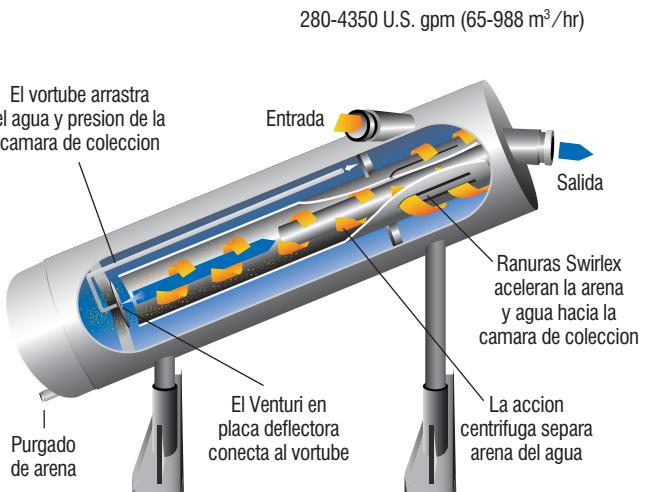
Diseñados para proteger aspersores y boquillas de aspersión de partículas abrasivas, asegurando el rendimiento efectivo de su aspersor, de su pivote central y de sus sistemas de riego en línea/avance lateral y sistemas de riego micro. Presentando el vortube patentado para aumento de eficiencia a bava perdida de presión.
