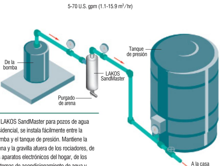
Un sistema único de filtración por acción centrífuga remueve las partículas de arena y sedimentos, tan finos como 200 mesh (74 micrones), sin partes móviles que se desgasten. Los Separadores de Arena LAKOS están diseñados para proteger a los rociadores y a las boquillas de riego de las partículas abrasivas, asegurando el rendimiento efectivo de su aspersor, de su pivote central y de sus sistemas de riego en línea o de avance lateral. El nivel de presión máximo de 150 psi (1055 kPa).
